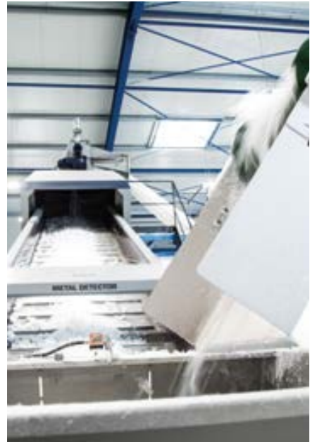
Lindner Antares und INTAREMA® TVEplus® im Zusammenspiel: Der Shredder übergibt die zerkleinerten Folienflakes an das Förderband der EREMA Maschine.
