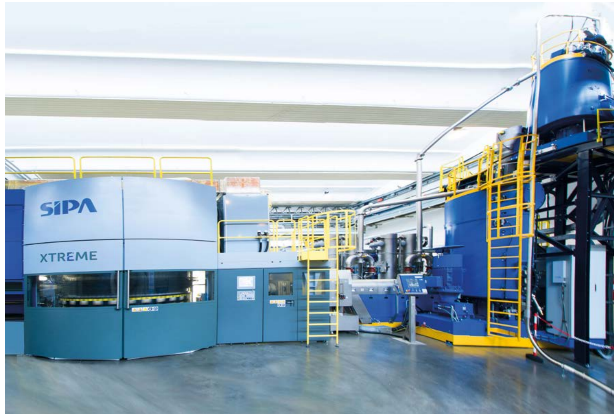
VACUREMA® Inline Preform Anlage: Das innovative Verfahren beruht auf der Zusammenführung der bewährten VACUREMA® Bottle-to-Bottle Technologie von EREMA mit dem XTREME Renew Preform Production System von SIPA.
