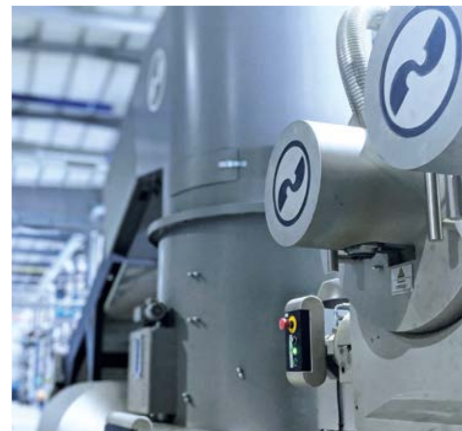
EREMA Laserfilter in Twin-Ausführung für effiziente Filtrierung: Störstoffe wie Papieretiketten, Aluminium oder auch von Multilayermaterial stammende Fremdpolymere wie PET oder PA werden selbst bei hohen Verschmutzungsgraden von bis zu fünf Prozent verlässlich entfernt.
