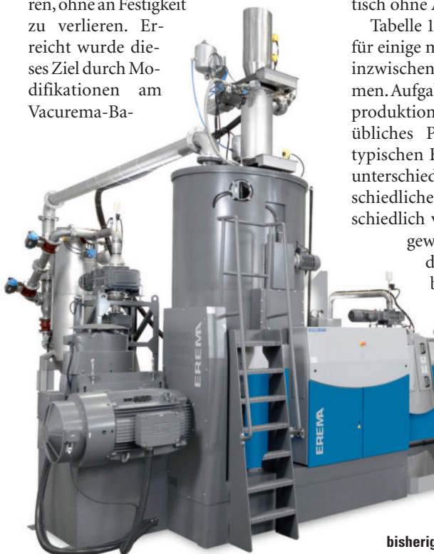
Bild 3. Zur IV-stabilen Aufbereitung der Schmelze aus Flaschenmahlgut hat der Vacurema-Reaktor ein gut doppelt so großes Volumen wie im bisherigen Standard und ist für ein Vakuum bis zu 10 mbar ausgelegt
