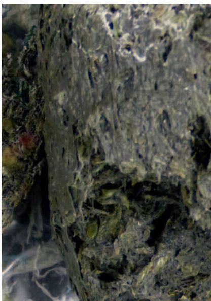
Bild 6. Bei der Filtration von PE-Waschschnitzel aus dem Post-Consumer-Sammelsystem erreicht der Laserfilter LF 4/350 eine Eindickung von 41 %
