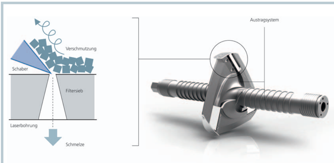
Bild 4. Mit der neuen Schaber-geometrie wird die Verschmutzung sofort vom Sieb abgehoben und direkt an das Austragsystem abgegeben
