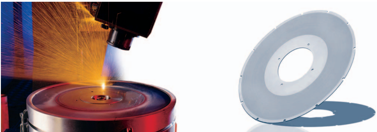
Bild 5. Links: Mit Lasertechnik werden konische Löcher in das Filtersieb eingebracht. Rechts: Gehärtetes Laserfiltersieb
