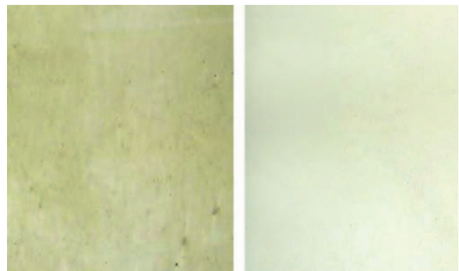
Bild 7. Diese Folienmuster wurden auf einem OCS Messextruder ME25/25D.V3 aus Rezyklat von PE-Waschschnitzel hergestellt. Links: mit marktüblicher Filtertechnologie hergestelltes Rezyklat. Rechts: mit Laserfilter und neuer Schaber-technik hergestelltes Rezyklat
