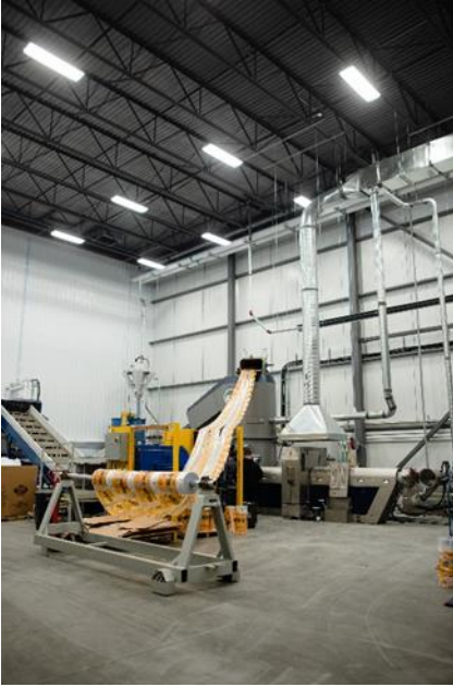
Post-commercial Verpackung wird auf einer EREMA Recyclinganlage verarbeitet. (© Polykar)
