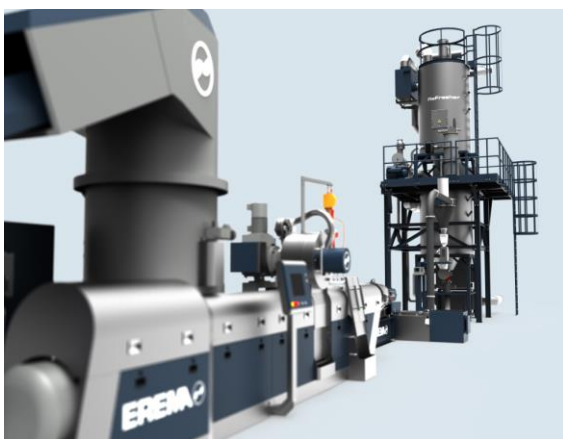
Bild 2: Die Kombination von ReFresher und der bewährten TVEplus-Technologie bietet selbst bei stark verschmutzten Verpackungsabfällen erstmals geruchsneutrale Rezyklate. Fotocredit: EREMA
