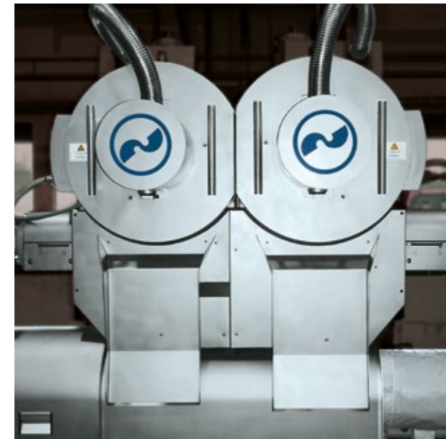
Filterwechsel ohne Maschinen-Stopp für kontinuierliches Produzieren – möglich mit dieser Spezialausführung des EREMA Laserfilters LF 2/354 TWIN
