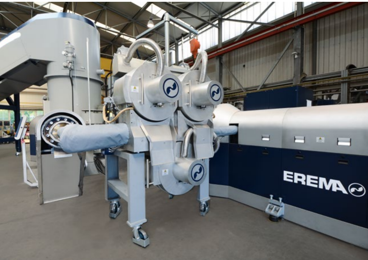
LF 2/354 TRIPLE in paralleler Anordnung für hohe Durchsatzkapazität
