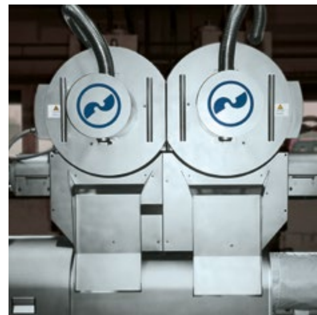
Wymiana filtra bez zatrzymania maszyny umożliwia ciągłą produkcję – jest to możliwe dzięki specjalnej wersji filtra laserowego EREMA LF 2/354 TWIN
