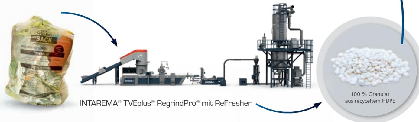
Maßgeblich für die hohe Dekontaminationsleistung dieser EREMA Technologiekombination sind die Vorbehandlung des Materials während der einstündigen Verweilzeit in der Preconditioning Unit des Recyclingextruders und die zusätzliche Entfernung schwer flüchtiger Geruchsstoffe aus dem Granulat durch die Anti-Geruchstechnologie ReFresher.
