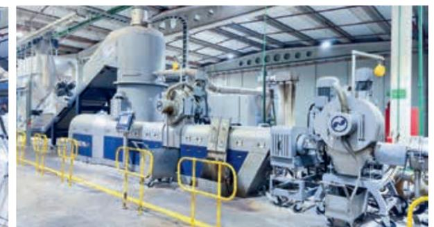
**Inputmaterial:** gewaschene (LD)PE Filmflakes (aus Waschanlage von Lindner Washtech) Verschmutzung: Papier, Holz, Klebebänder (Fremdpolymere) INTAREMA® 1512 TVEplus® DuaFil® Compact
