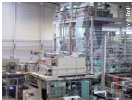
La empresa procesadora de plástico fabrica 15.000 toneladas anuales de film flexible de 3 a 14 capas en un total de ocho líneas de extrusión de film soplado.
