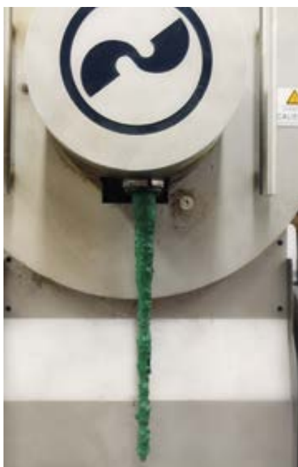
El Laserfilter de EREMA tiene un mecanismo de autolimpieza continua.
