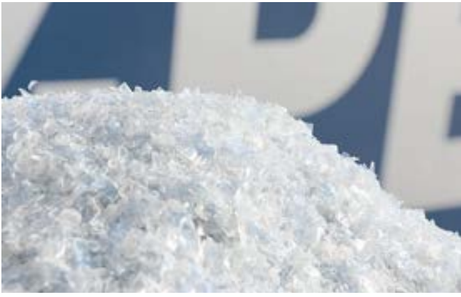
Para producir láminas de rPET de termoformado aptas para el contacto alimentario (imagen inferior izquierda), Snelcore emplea principalmente escamas de botellas de postconsumo (imagen izquierda). No obstante, gracias a la gran flexibilidad de la tecnología VACUREMA®, también puede mezclar residuos de refilos (imagen derecha), retales de termoformado o productos nuevos para utilizarlos como material de entrada.
