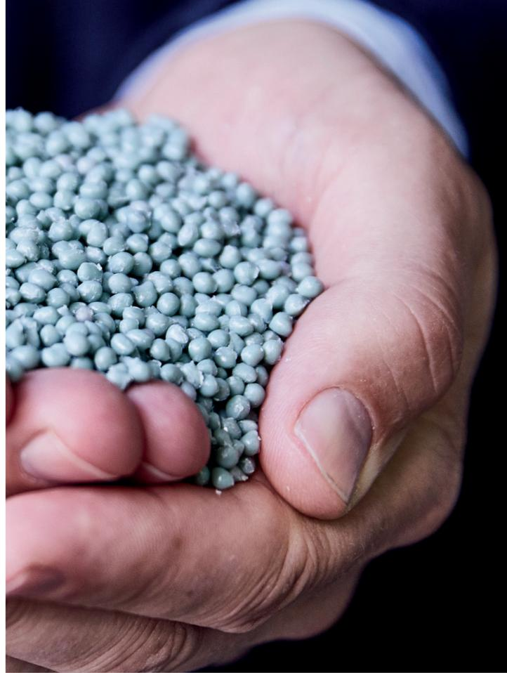
Im firmeneigenen Recyclingwerk „CIRREC“ in den Niederlanden, werden die von Sammel- und Sortierunternehmen aus ganz Europa bezogenen PET-Ballen sortiert, gewaschen und recycelt. Die rPET-Flakes und das Regranulat werden sowohl an Verpackungshersteller geliefert als auch in der eigenen Produktion wieder eingesetzt. (Bilder: Faerch A/S)
