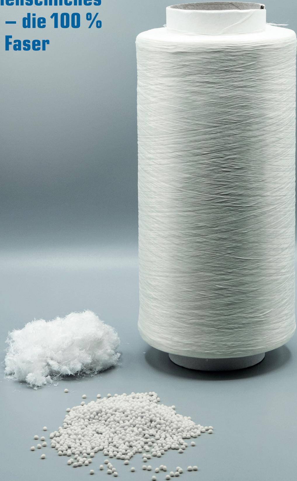
*Faserabfall aus der Filamentfaserproduktion (links), das hochqualitative Regranulat, zu dem es recycelt wurde (vorne) und eine aus diesem Regranulat mit Filamenttechnologie
