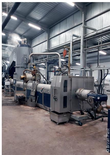
Das patentierte Extrudersystem INTAREMA® 1714 TVEplus® hat Dejan Simic überzeugt: „Dank dem Qualitäts-Regranulat können wir wieder hochwertige Produkte herstellen und verhindern damit, dass wertvolle Kunststoffabfälle auf Deponien oder in der Verbrennung landen.“
