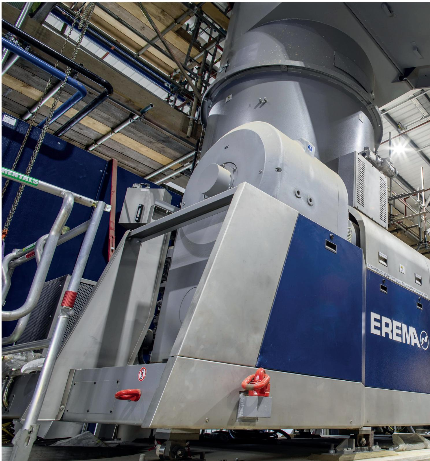
Das CHEMAREMA® Einschneckenextrusionssystem mit Counter Current Preconditioning Unit für alle Einsatzstoffe im chemischen Recycling.
