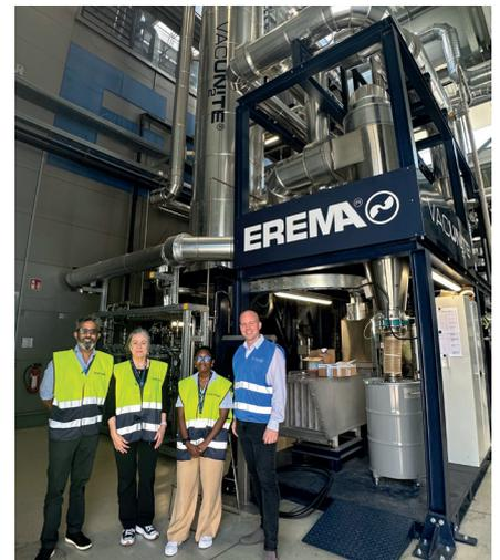
*Der SSP-Teil der hochmodernen Bottle-to-Bottle Recycling Anlage VACUNITE®.*
