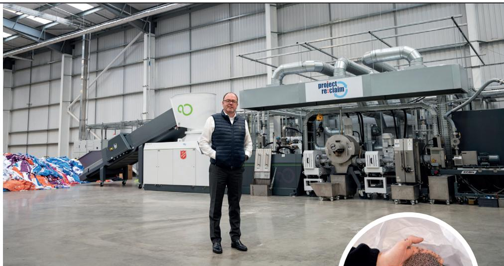
*Auf der ISEC evo des EREMA Schwesterunternehmens PURE LOOP entsteht aus Polyester-Alttextilien hochwertiges rPET, das in Form von Garnen oder anderen Produkten in den Kreislauf rückgeführt wird.*
