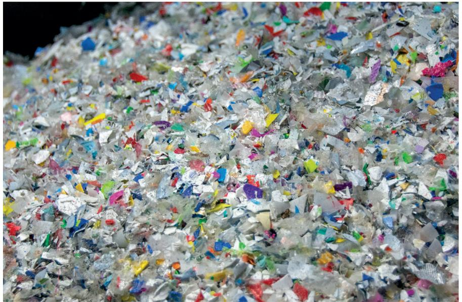
*Polyolefin-Mahlgut kurz bevor es von der INTAREMA® 2325 zu Top-Regranulat für hochwertige Recycling-Endprodukte aufbereitet wird.*
