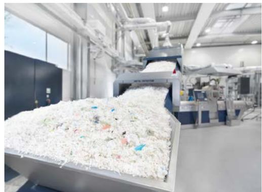
INTAREMA<sup>®</sup> TVEplus<sup>®</sup> mit Laserfilter für das Post Consumer Recycling
