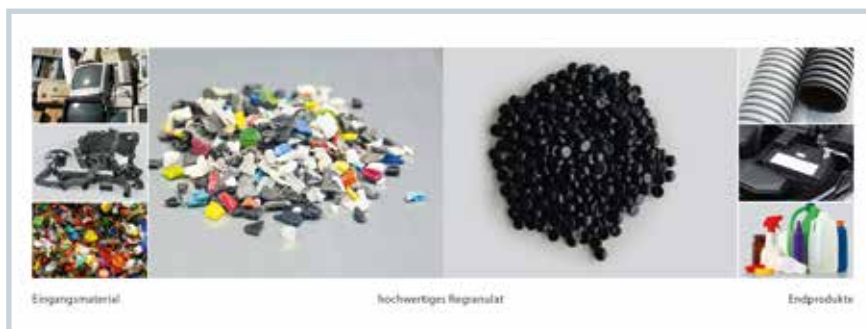
Bild 1. Die neue Intarema-RegrindPro-Technologie: Für Kunststoffverarbeiter stellt Regranulat auf Basis von Mahlgut (dickwandige Verpackungen, WEEE und Automotive) eine hervorragende Alternative zu Neuware dar
