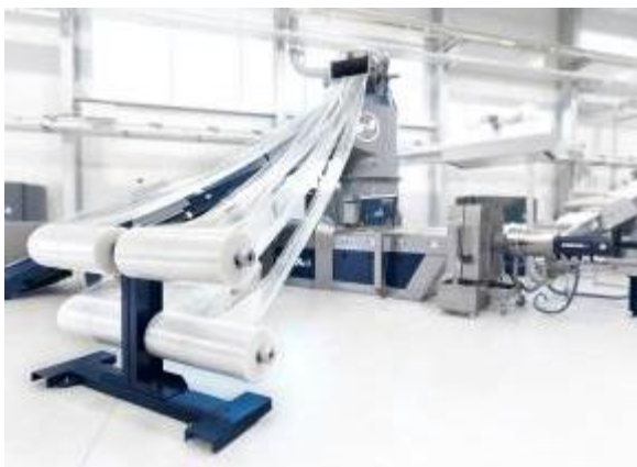
Bild 2: Am EREMA Messestand W1249 werden auf einer INTAREMA® T 1108 saubere LDPE-Folienabfälle im Live-Betrieb zu hochwertigen Rezyklaten verarbeitet. Fotocredits: EREMA
