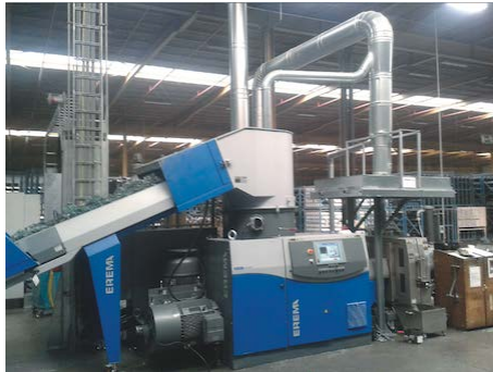
Die COREMA® 1109 T Anlage bei Beaulieu Technical Textiles in Belgien sorgt für eine effiziente Entgasung der Spinnölanteile im Schneidverdichter
