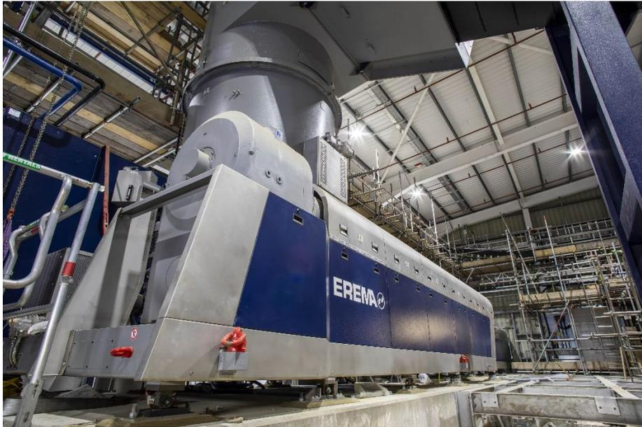
*Bildunterschrift: Das EREMA CHEMAREMA® Einschneckenextrusionssystem mit Counter Current® Preconditioning Unit für alle Einsatzstoffe im chemischen Recycling*
