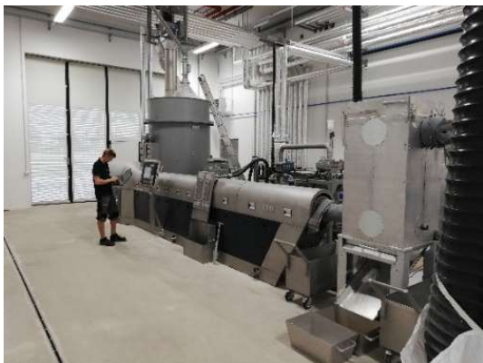
Bildtext: Das Recyclingsystem ist eine anwenderspezifische Kombination einer INTAREMA 1512 TE Recyclingmaschine mit einem Schmelzefilter zur Feinfiltration von der Lindauer DORNIER GmbH. Foto: DORNIER
